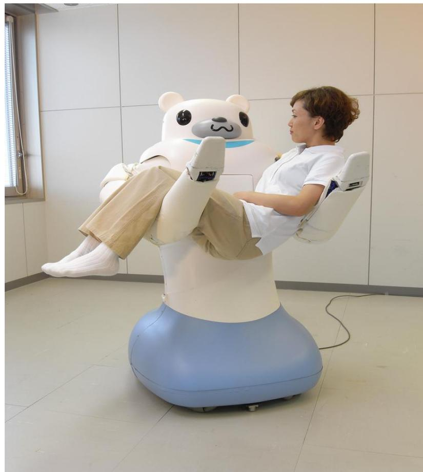
**BEAR** 1,8 метра. Максимальный вес, переносимый роботом, составляет 270 кг
